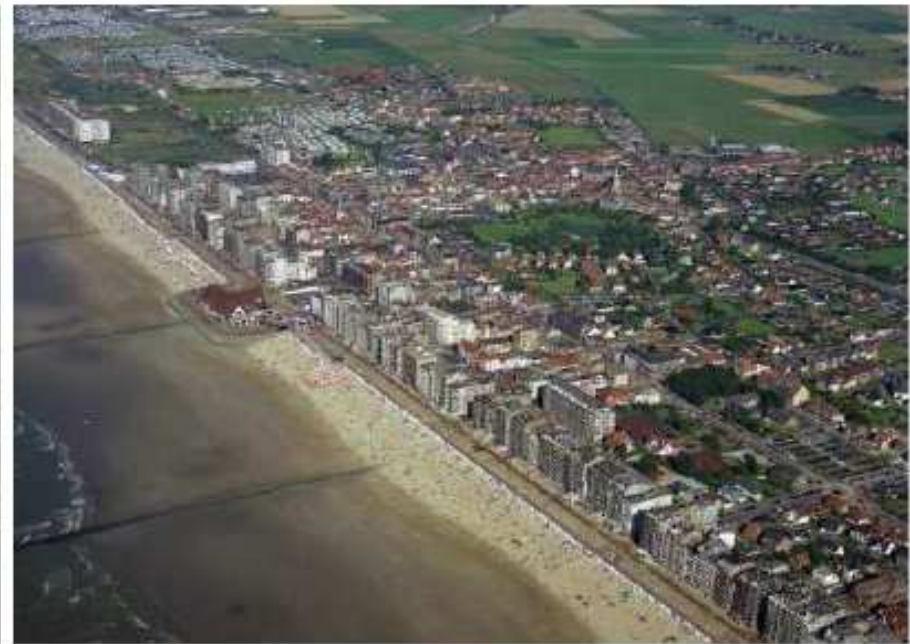
Middelkerke: hoe harde zeeweringen en uitsprongen met een nauw strand resulteren in een onveilige situatie
